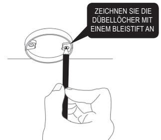
Benutzen Sie den Montagesockel, um die Dübellöcher an der Decke oder an der Wand zu markieren.
